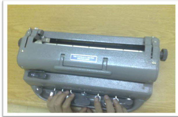
طريقة وضع الأصابع لمفاتيح آلة برايل (بيركنز)
